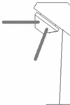
1.10 Fixar os braços da catraca. Para isso são utilizados dois parafusos tipo allen sem cabeça (embutidos no cubo da catraca) em cada braço. O primeiro fixa o braço ao cubo e o segundo serve de contra aperto para evitar o afrouxamento do primeiro. Para sua fixação deve ser utilizada uma chave allen de 4 mm.
