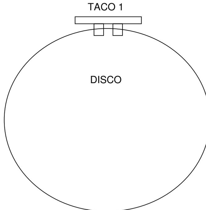
OBS: O tacômetro deve estar posicionado de forma que o disco possa girar livremente entre a fenda dos sensores.
